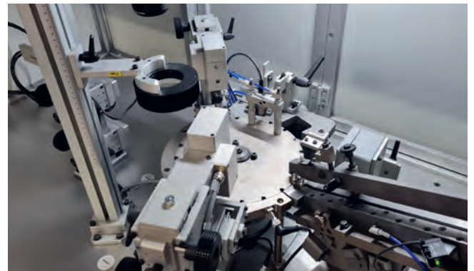
Slot-tányér: A függesztett részeket oldalirányból vizsgálják. Lehetőség van 360 fokok és örvényáramú vizsgálatokra.
